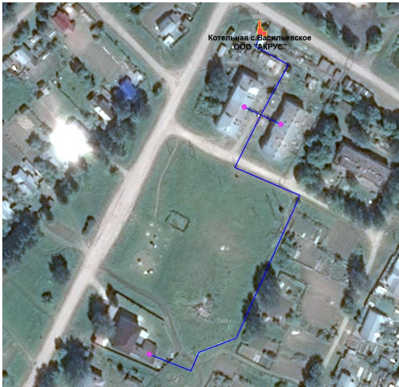
Рис.2. Схема тепловых сетей котельной Васильевского сельского поселения с привязкой к топографической основе.
