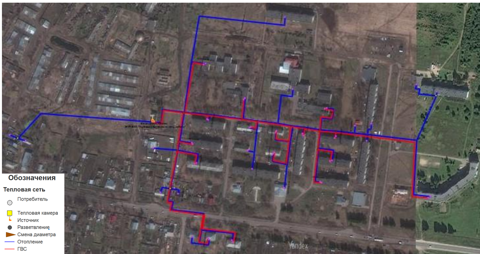
Рис.2. Схема тепловых сетей котельной с. Китово Китовского сельского поселения с привязкой к топографической основе.
