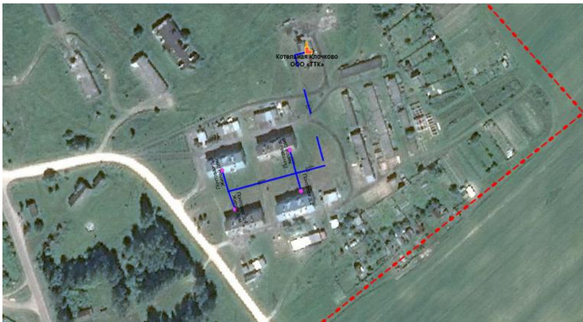
Рис.5. Схема тепловых сетей котельной д.Ключково с привязкой к топографической основе.
